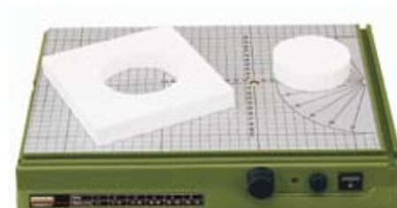
Pro řezání oblých tvarů je jednoduché řešení: připevněte (např. izolepou) napínáček ke stolu. Slouží jako otočný bod.
